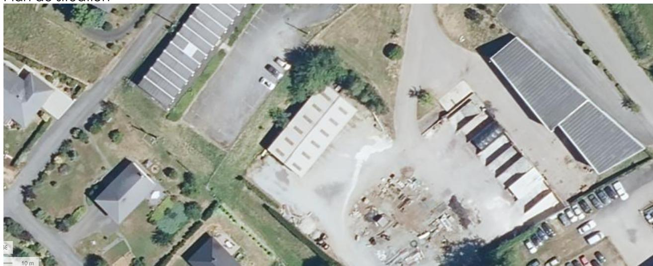
Le bâtiment constitué d'une toiture à 2 pans offrant une surface disponible d'environ 250 m<sup>2</sup> est dimensionné pour recevoir des panneaux photovoltaïques.
